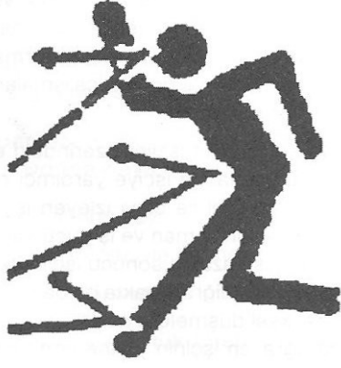
Resim 13. Makinelere operatöre parça veya malzeme fırlaması
