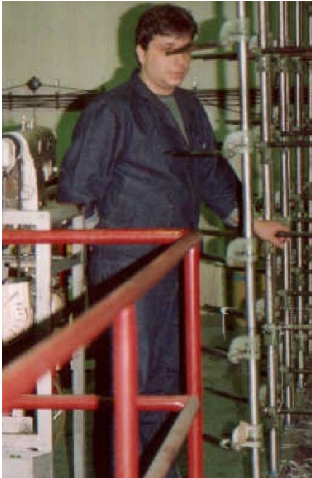
(Tekstil fabrikasında terbiye edilecek iplerin takıldığı iğ'ler ve operatör)
