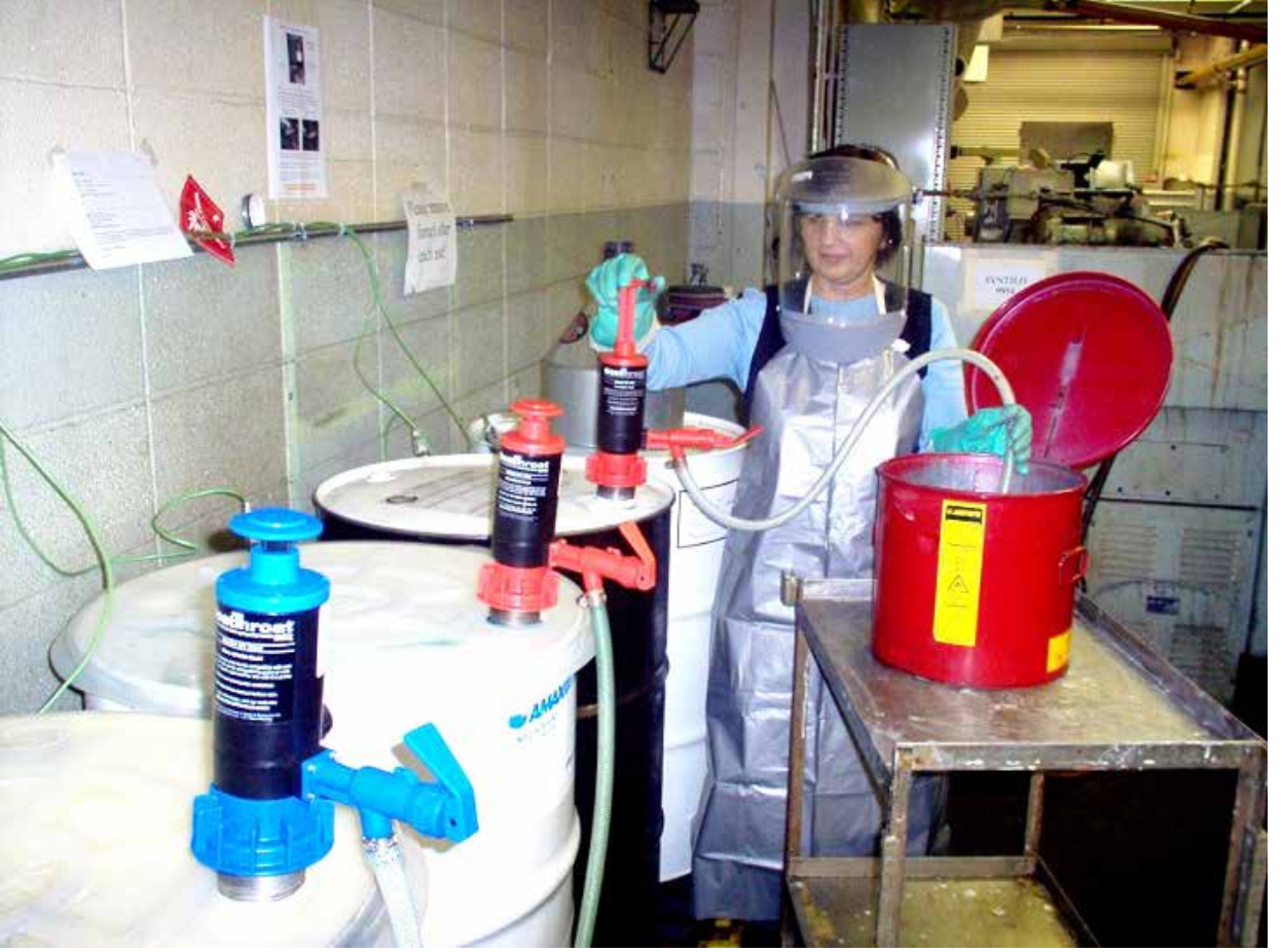
Resim 11- Yanıcı ve parlayıcı kimyasal bulunduran kapların gövde topraklaması yapılmıştır. Kıvılcım çıkarmayan pompalarla gerekli kişisel koruyucu donanımını kullanan işçi tarafından transfer yapılmaktadır (28) .
