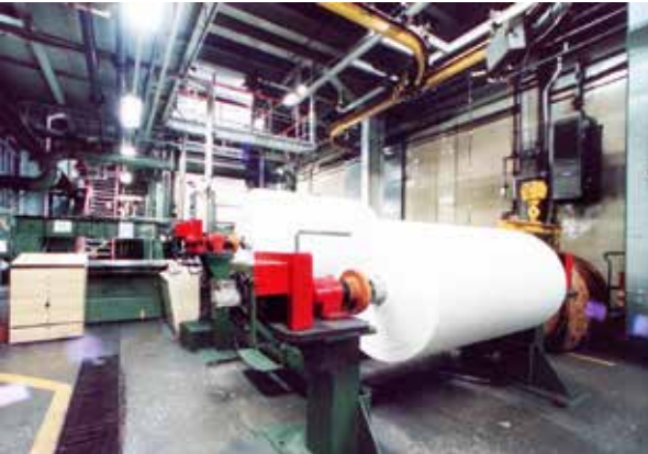
Resim 5 - İşyerinin terbiye ünitesinin let-off (ham bezin terbiye ünitesine giriş yaptığı – salıverildiği) bölümü.
