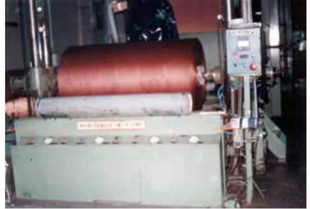
Resim 6– Terbiye etme (bir sonraki üretimde kullanılacak yapışkanlığa ve fiziksel özelliklere kavuşturulan) işleminin tamamlanmasından sonra terbiye ünitesinin wind-up (sona ermek) bölümünde mamül bezin çelik göbeğe/silindire sarılması (6) .
