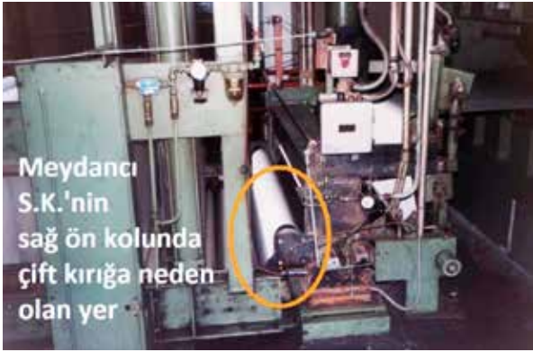
Resim 7- Terbiye ünitesi Let-off'un hemen yakınında iş kazasının meydana geldiği yer.
