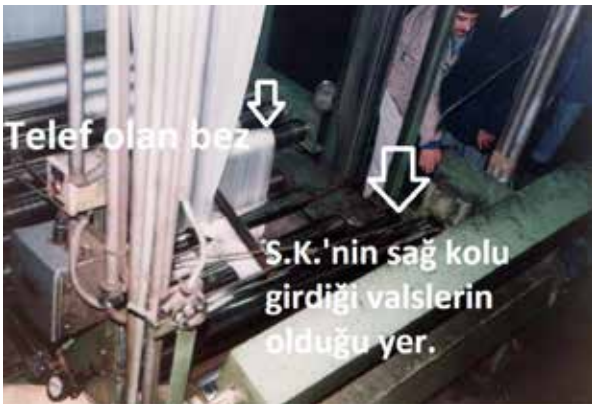
Resim 8- Dakikada 120 m hızla giden bezin katlanan kenarını açmak isterken valsler (dönen silindirler) arasına S.K.'nin kolunu kaptırdığı yer.
