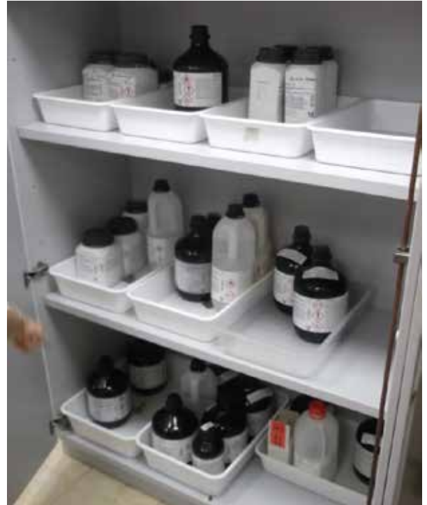
Resim 2 – Depolarda, kimya vb. laboratuvarlarda bulunan her bir kimyasal kabının altına, o kimyasallara dayanıklı güvenlik kabı konmuş/konmalı.
