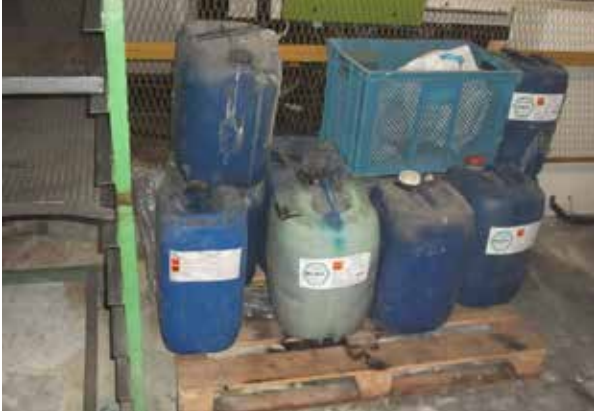
Resim 3- Kapı kolu vb. aksesuarların üretildiği bir fabrikada depolanan sülfürik asit bidonundan sızan/dökülen (sülfürik asit) tahta paleti yakmış (yangın başlangıcına neden olabilir!).
