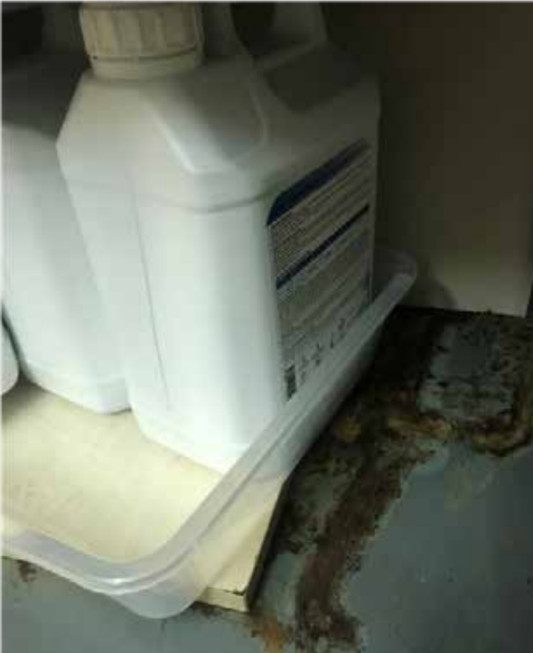
Resim 1 – Bir sağlık kuruluşunda kullanılan dezenfektan vb. depolandığı çelik raf. Depolanan ürünün kabından akan kimyasal çelik rafta korozyona neden olmuş.
