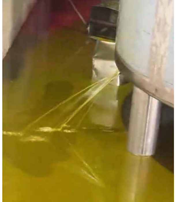
Resim 8- Kaynak yerinden patlayan zeytinyağı depolama tankı (19,20) .
