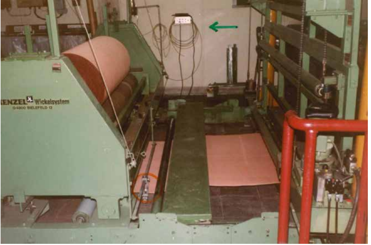
Resim 6- Endüstriyel bez en ve boy ayarlama makinası fotosel aparatı ve ilave edilen geçiş platformu (Fotoğraf: Mustafa Taşyürek)
