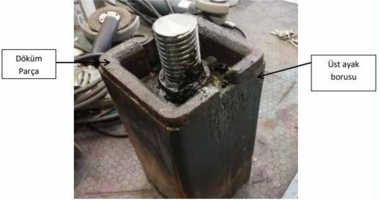
Fotoğraf 8 - 2 Numaralı Ayak – Alt Boru Döküm Parça Bağlantısı (17)
