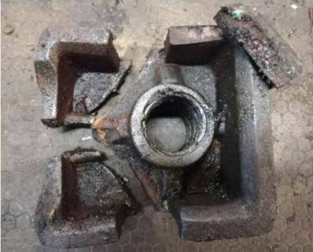
Fotoğraf 7- 1 Numaralı Ayak Döküm Parçaları Kırılma Bölgeleri (17)
