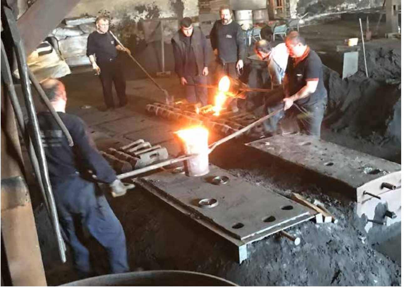
Fotoğraf 13 – Dorse devrilmesine neden olan döküm parçasına benzer makine parçalarının üretildiği bir dokümhane
