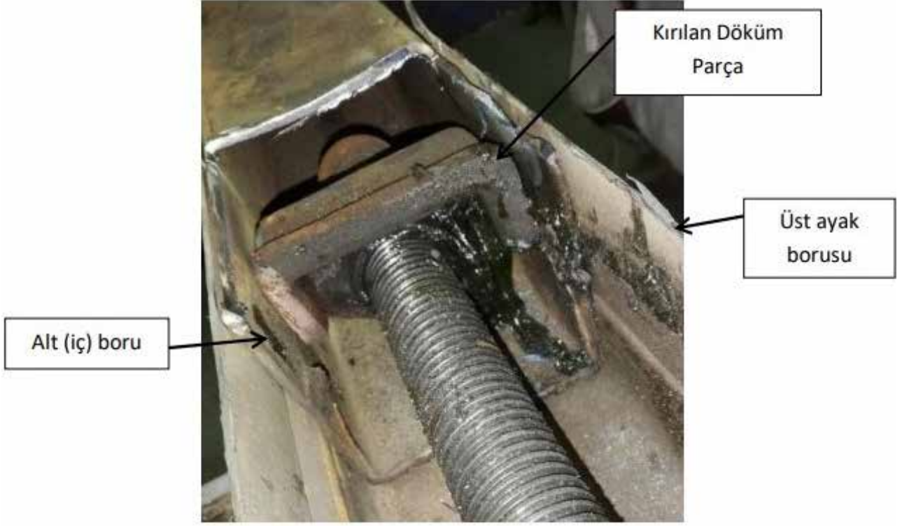
Fotoğraf 6 - 1 Numaralı Ayak Döküm Parçaları Kırılma Bölgeleri (17)
