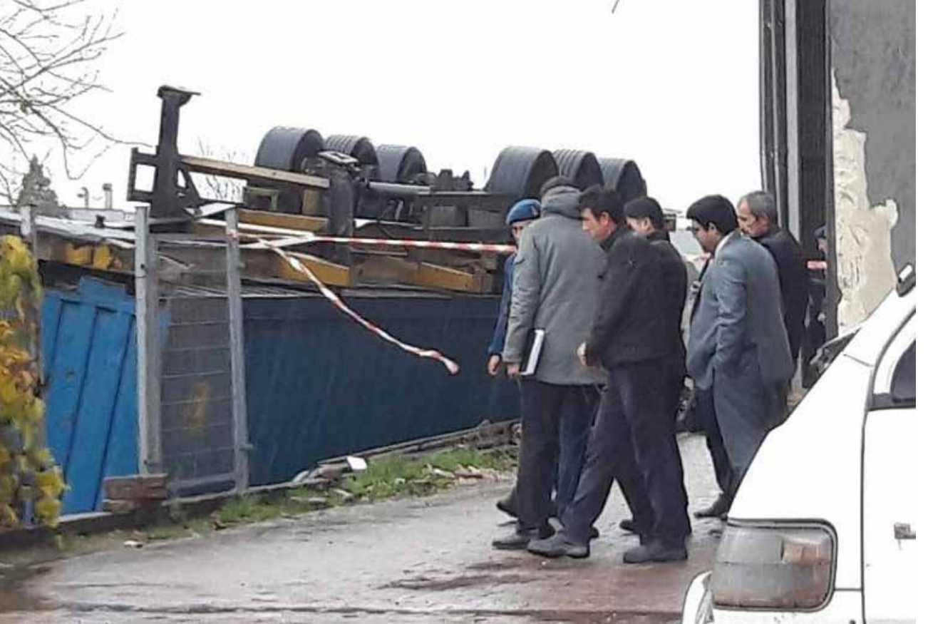
Fotoğraf 1 – Yükleme sırasında destek ayaklarından birinin kapanması sonucu ters dönen dorse ve üzerindeki konteyner (12,13)
