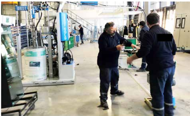
Resim 4 - Çift komponentli yüksek esnekliğe sahip hızlı kürlenen* , özellikle çiftcam ünitelerinin kenar sızdırmazlığı için geliştirilmiş nötr silikonun cam kenarlarına uygulanması (Foto: M.Taşyürek)
