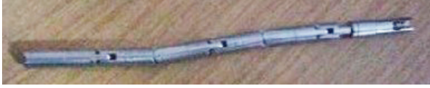
Resim 6- Test cihazından düşülen iridyum 192 kaynağı (10)
