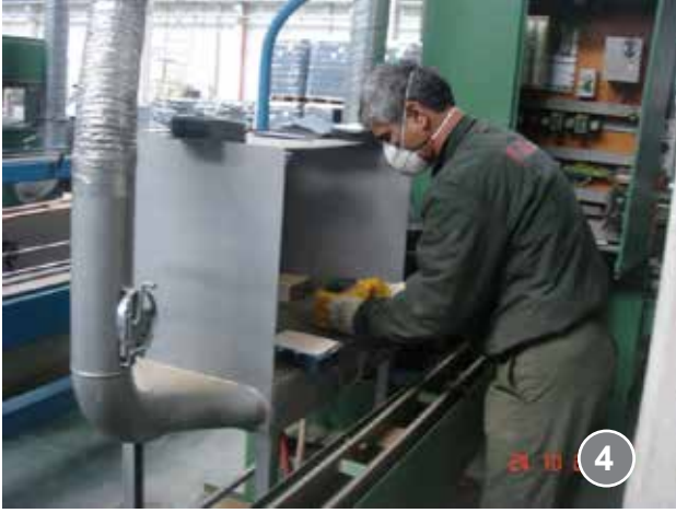
Resim 4, 5- Kurşun oksit sıvanmış akü ızgaralarının alttan emişli aspirasyon sistemli tezgah üzerinde zarflama vb. işlemleri
