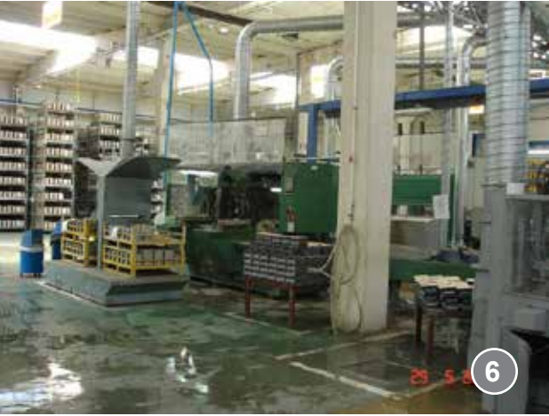
Resim 6, 7 - Toz yayılımını önlemek için ıslak çalışma yönteminin uygulanması, ve hurda kurşun ve kurşun oksitli atıkların toplandığı ağız kapalı toplama kapları
