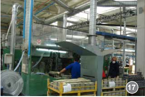
Resim 17, 18 - Olası kurşun oksit toz yayılımını önlemek için alttan ızgaralı (damla tavalı) ve yandan emişli aspirasyon sistemi ve çalışma zeminini ıslak yöntemle temizleme yapılması
