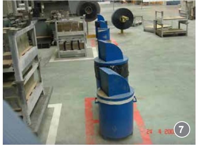
Resim 6, 7 - Toz yayılımını önlemek için ıslak çalışma yönteminin uygulanması, ve hurda kurşun ve kurşun oksitli atıkların toplandığı ağız kapalı toplama kapları
