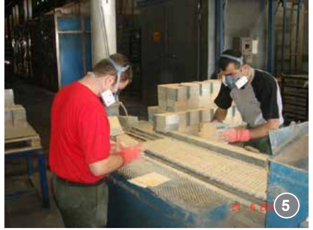
Resim 4, 5- Kurşun oksit sıvanmış akü ızgaralarının alttan emişli aspirasyon sistemli tezgah üzerinde zarflama vb. işlemleri
