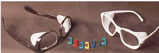
Resim 6 – İşyerinde gözüne fırlayan kopçanın çarptığı işçiye verilen güvenlik gözlüğü ve kopça örnekleri.
