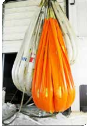
Resim 16,17- Yük testi için su torbalarından (balonlardan) yararlanılması.
