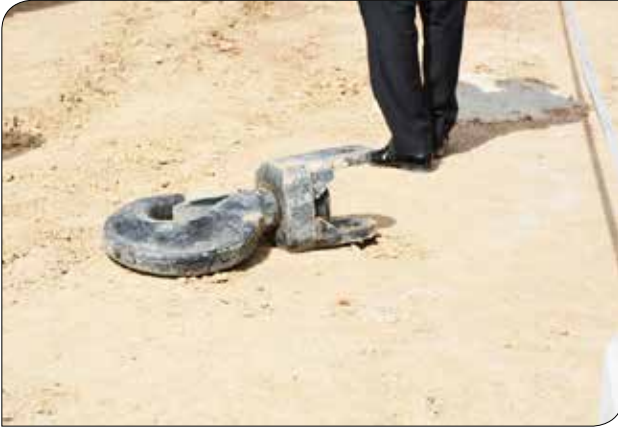
Resim 3 – Vinç halatından kopan vinç kancası
