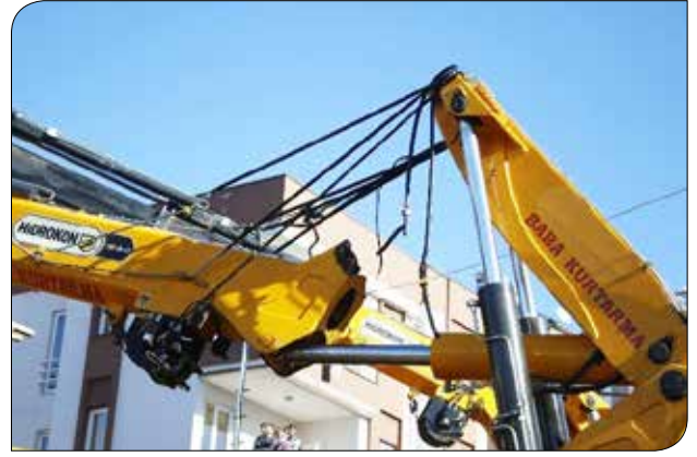
Resim 5 – Vinç bomunun kırıldığı yer
