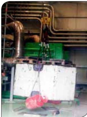
Resim 14,15 – Yük testinin beyan edilen yükün 1.1 katından 1.25 katına çıkartılması ve kontrollerin yapılması
