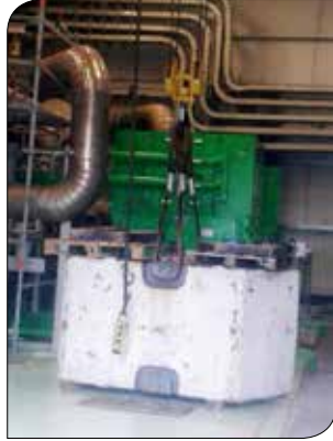
Resim 12, 13 – Yük testi öncesi mekanik ve elektrik aksamının gözle kontrolü ve ağırlık testinin uygulanması
