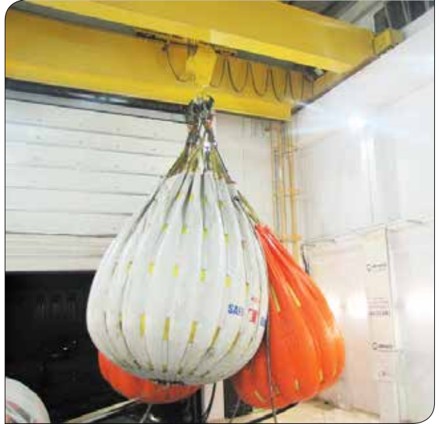
Resim 18- Su torbalarından (balonlardan) yararlanarak statik ve dinamik testlerin yapılması
