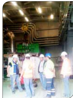
Resim 14,15 – Yük testinin beyan edilen yükün 1.1 katından 1.25 katına çıkartılması ve kontrollerin yapılması
