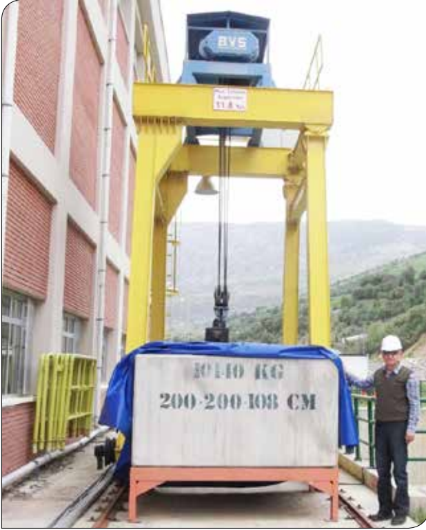
Resim 19 – Yük testi için ağırlık taşımanın güç olduğu yerler için hazırlanan beton ağırlık kütleleri.
