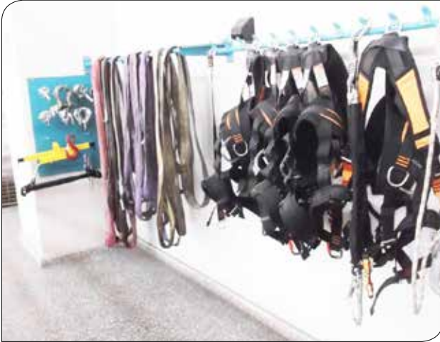
Resim 20 – Kaldırma aksesuarlarının bozulmayacak veya hasar görmeyecek şekilde (serin, kuru, ışık ve ısıya doğrudan maruz kalmayacakları yerde) muhafaza edilmesi (24) .
