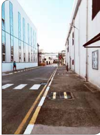
Resim 9 – İşyeri içerisinde forklift ve yaya yollarının işaretlenmesi
