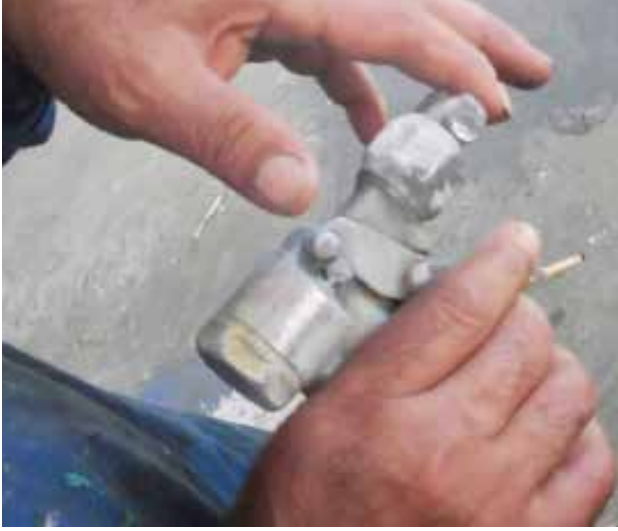
(Kazayı oluşturan boya püskürtme tabancası ve memesinin temizlenme şekli)
