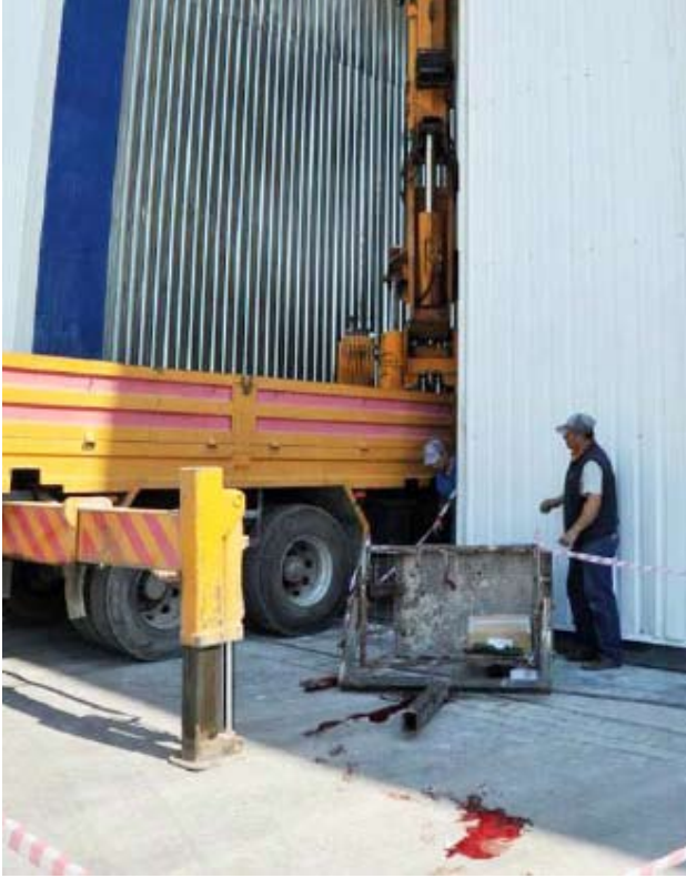
Resim 1 - Vinç sepetinin bağlantı piminin / vidasının yerinden çıkması (7,8,9)
