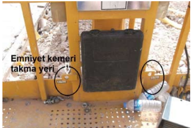
Resim 9b – Çalışma sepetinde emniyet kemeri sepette bağlanması gereken yer.
