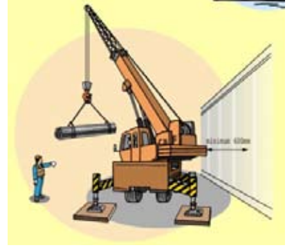
Şekil 10: Vinç ve emniyetli aralık
