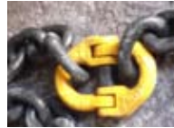
Resim 19: Zincirin uygun bağlanma aparatı
