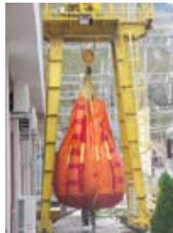
Resim 21: Balon ve su ile vinç testi
