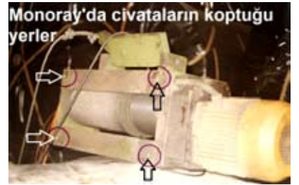
Resim 14: Civataları koparak düşen monoray
