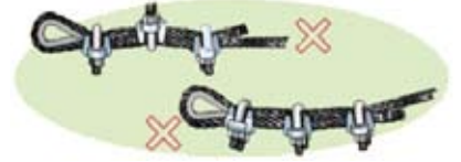
Şekil 3: Halatın yanlış bağlanması
