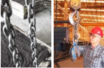
Resim 16: Kaynatılabilir zincir baklaları Resim 17: Civata ve somun ile kısıtlanmış zincir
