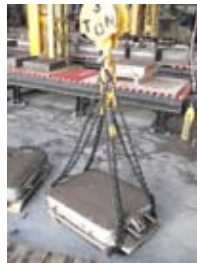
Resim 18: Uygun bağlanmış zincir
