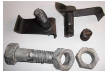
Resim 15: Monorayın kopan civataları ve sıyrılan civata/somun parçaları
