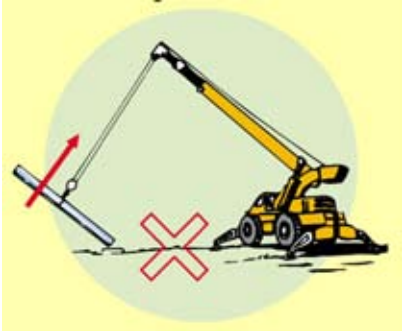
Şekil 5: Vincin yanlış kullanılması
