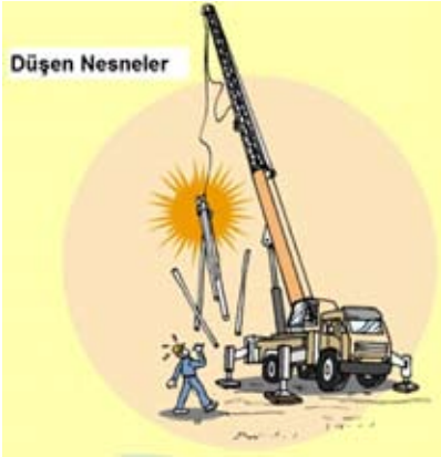
Şekil 16: Vinç ile çalışırken tehlikeli bölge
