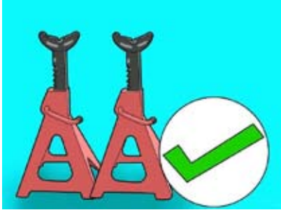
Şekil 7: Çift stand kullanılması
