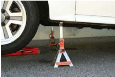
Resim 20 : Kriko ve kriko standlarının kullanılması (36)
