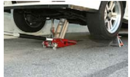
Resim 19: Kriko ile kaldırılan araç kriko standları üzerine oturtulması
