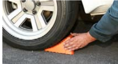
Resim 17: Araçların lastikleri ön ve arkaya takozlanmalı
