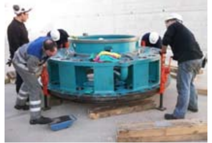
Resim 1 : Kriko ile kaldırılan tonlarca ağırlığında HES mekanizması
