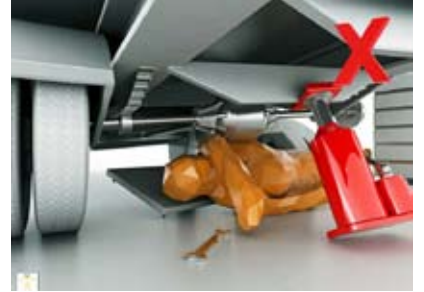
Şekil 1 : Sadece kriko ile araç kaldırma (35)
