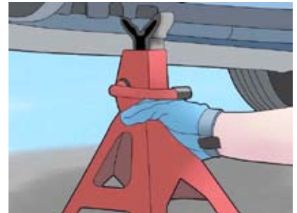
Şekil 5: Kriko standları. Aracın belirlenen kaldırma noktasına yerleştir.
