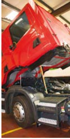
Resim 21 : Bir TIR kupası için destek
