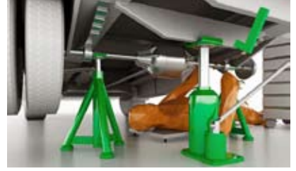
Şekil 8: Krikonun güvenli kullanılması örneği
