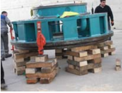
Resim 16: Altına girilecek ağırlığın en az 5-6 noktadan dengeli detek üzerine oturtulması
