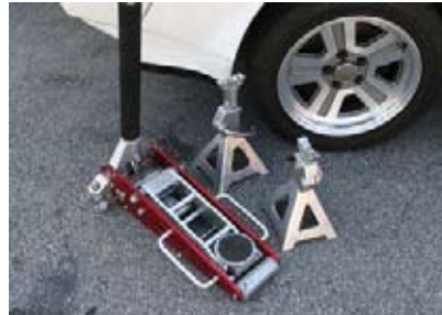
Resim 18: Araç kaldırmak için gerekli olan kriko ve kriko standı
