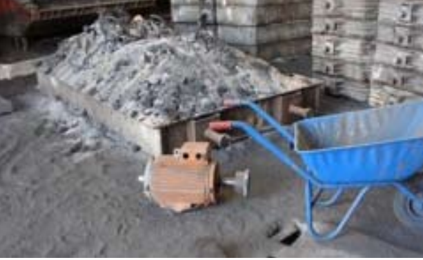
Resim 3: Aşırı yükten kırılan vincin motorlarından biri
