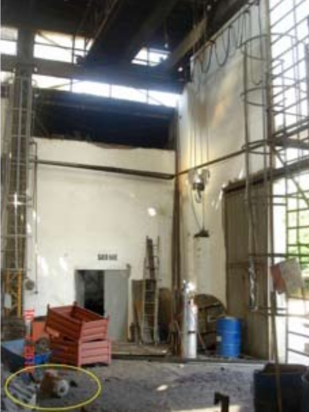
Resim 4: Tavan altı vinç ve kopan parçası
