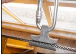
Resim 5: Yatay yaşam hattında emniyet kemerinin bağlanma yeri
