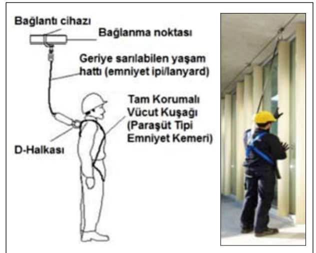
Şekil 3: Ankrāj ve Resim 3: noktası ve diğer düşme önleme tertibatı [Dhalkası veya karabinalar asgari (minimum) 2268 kg (5000 pound / 22,2 kN) gerilme mukavemetine sahip olmalıdır. Çatlama, kırılma veya kalıcı deformasyona neden olmayacağı 1633 kg, 'lık (3,600 pound (16 kN)) dayanıklılık testi yapılmış olmalıdır [9] ].
