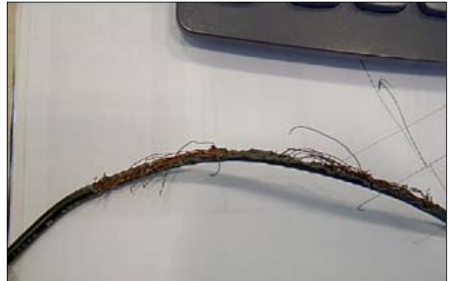
Fare veya sıçan'ın düşük gerilim kablosunda yaptığı tahribat
