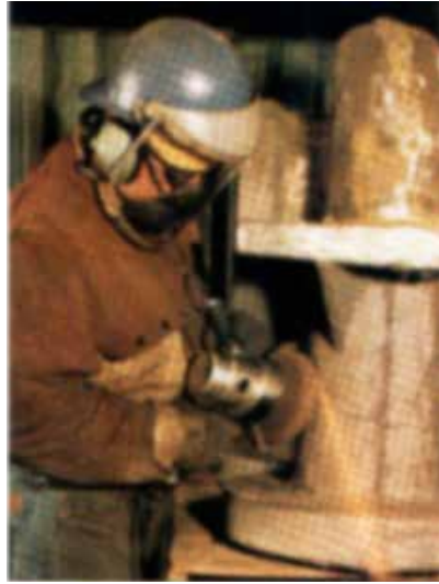
Resim 8- Döküm taşlama işçisinin -olması gereken- güvenli çalışma donanımları.
