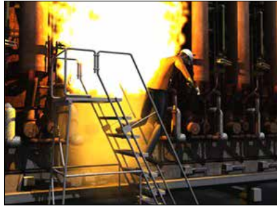
Resim 8: Demir tozunu patlamanın ardından çıkan yangın.
