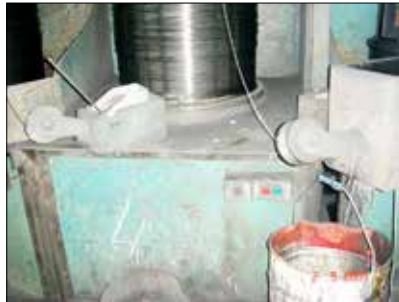
Resim 1 ve 2: Kuru tel çekme makinası ve ortama yayılan ve biriken demir tozları.
