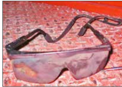
Resim 5: Elektrik ark flaş patlamasına sunuk kalan elektrikçinin güvenlik gözlüğü.
