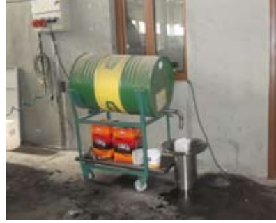
Resim 1: Küçük kaba makina yağının alınması sırasında işyeri zeminine dökülen makina yağı.
