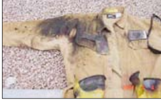
Resim 24 – Elektrik Şaltında ark patlamasına maruz kalan elektrikçinin iş gömleği ve eldivenleri (26,27)
