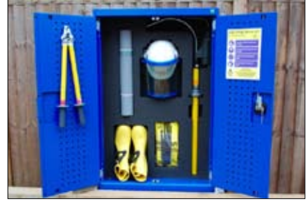
Resim 27 – Yüksek Gerilim Kurtarma KIT'i - Elektrik tehlikeleri için acil durum ekipmanı kutusu
