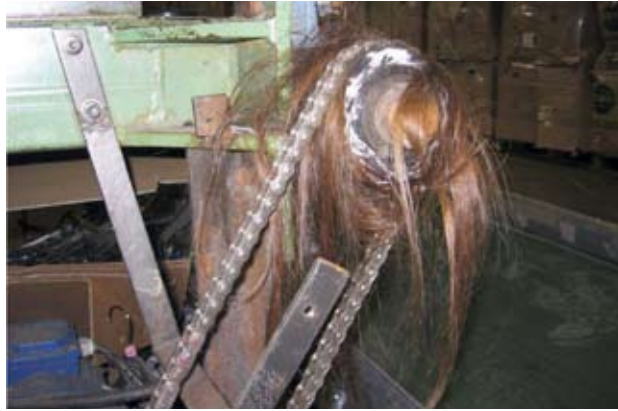
Şekil 6 : Bayan işçi Kelly Nield (24)'in saçları, geri dönüşüm konveyör bantının dişli ve zinciri arasında [25,26].
