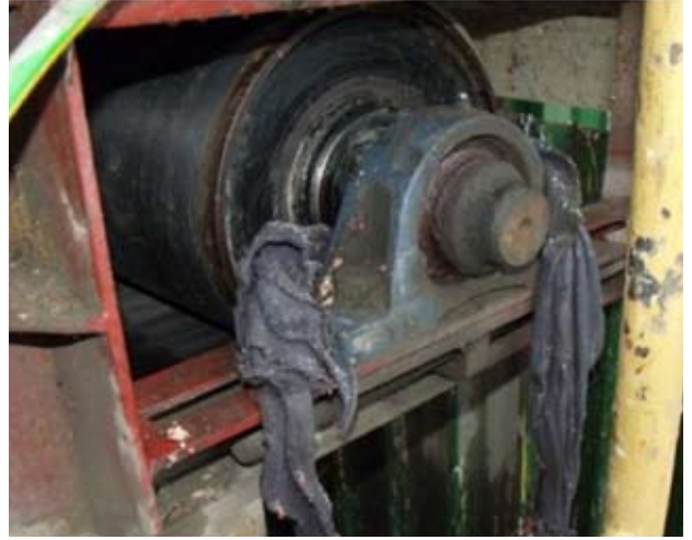
Şekil 7 : Kolunu vals ve kayış arasına kaptıran işçinin giysi parçaları [27,28]
